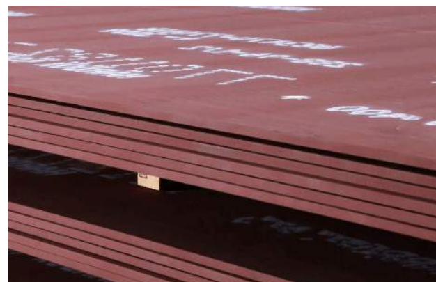
Thép chịu mài mòn Hardox Hardox wear-resistant steel
